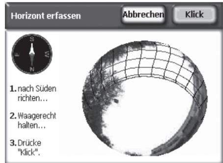
**Hinweis:** Die Werte für den Panelazimut sind genaue und keine magnetischen Werte.
