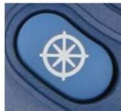
Passer directement à la vue Orientation. Cette fonction est utilisée pour mesurer la direction (azimut) du réseau solaire ainsi que l'inclinaison du réseau ou la pente du toit.
