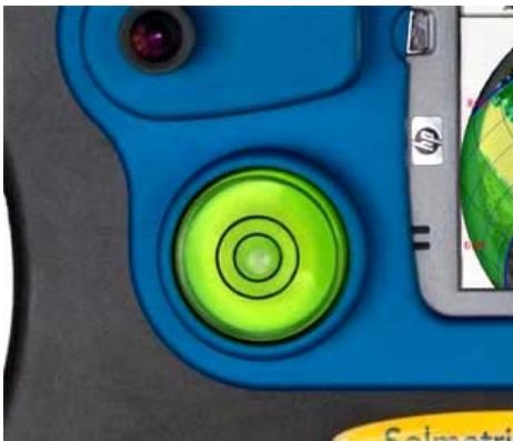
**HINWEIS** *Die Genauigkeit der Messung hängt direkt mit der Nähe der Kompasspunkte zum magnetischen Süden sowie der horizontalen Ausrichtung des Geräts zum Zeitpunkt der Horizonterfassung zusammen. Sie sollten während dieser wichtigen Schritte sehr sorgfältig vorgehen.*
