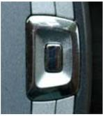
Die Fünf-Wege-Navigationstaste kann ebenfalls für die Eingabe vieler Navigationsfunktionen auf dem Bildschirm des Solmetric SunEye™ verwendet werden. So können Sie beispielsweise die Fünf-Wege-Navigationstaste dazu verwenden, durch Menüs zu blättern.
