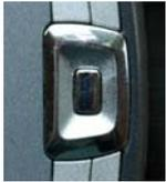
El botón de navegación de 5 direcciones también puede proporcionar entrada a muchas de las funciones de navegación que aparecen en la pantalla Solmetric SunEye™. Por ejemplo, puede utilizar el botón de 5 direcciones para desplazarse por los menús:
